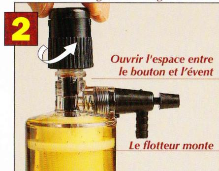
**2** Großer Abstand zwischen dem Knauf und der Entlüftungsöffnung
